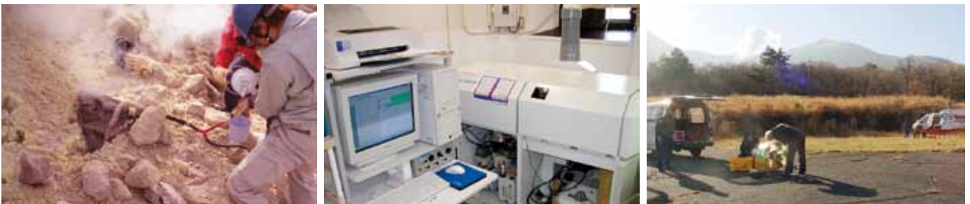
(左) 九重火山における火山ガス採取 (地球熱学研究施設・別府) (中) 分析装置 誘導結合プラズマ質量分析計: 岩石等の微量元素 (数pptまで測定可能) 濃度を分析することで、その形成過程を議論することができる (地球熱学研究施設・別府) (右) 観測風景 ヘリコプターを利用して火山活動に伴う磁場の変化を捉える。磁力計とGPS受信機を搭載したバードの最後の調整。背景は九重硫黄山の噴気。(火山研究センター・阿蘇)
