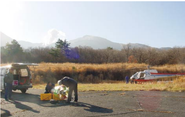
観測風景 ヘリコプターを利用して火山活動に伴う磁場の変化を捉える。磁力計とGPS受信機を搭載したバードの最後の調整、背景は九重硫黄山の噴気 (地球熱学研究施設火山研究センター・阿蘇)
