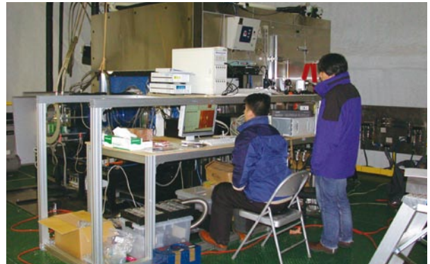
すばる望遠鏡用観測装置 光ファイバーを用いた多天体同時分光観測装置 (FMOS) の冷却分光器部分。すばる望遠鏡ドーム内に設置 (宇宙物理学教室)
